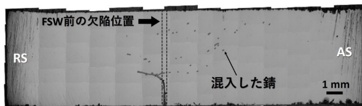
図3.1.4-10 錆びた模擬欠陥を有する鋼板を水中FSWして得られた断面マクロ写真（欠陥幅：0.3 mmの位置）
