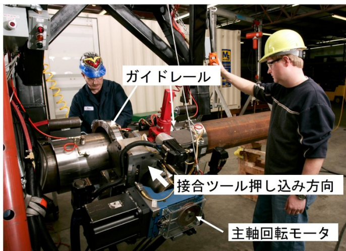
図 3.1.4-14 パイプライン敷設工事向けのFSW装置
