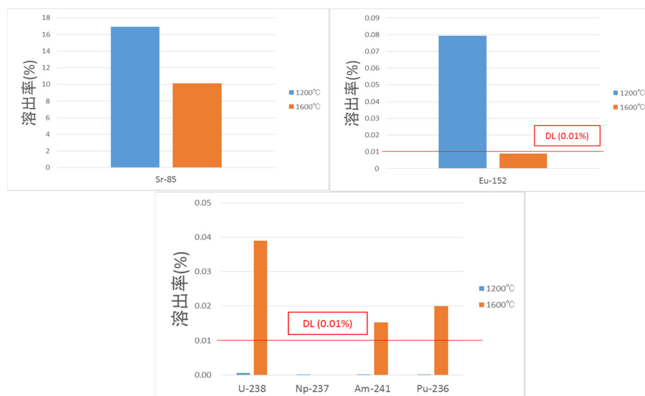
図 3.2.1-4 UO 2 -ZrO 2 -CaO 及び SiO 2 (酸化系)模擬デブリ (合成温度 1200°C及び 1600°C) から海水への各核種の溶出率 (浸漬液：海水、温度：25°C、浸漬期間：30 日間)
