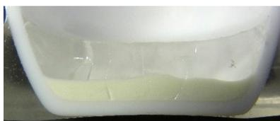
図 3. 2. 5(2)②-14 900°Cで熔融した  $\text{Na}_2\text{O-ZnO-B}_2\text{O}_3$  ガラスの断面写真
