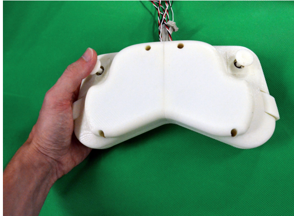
図 3.1-89 SEA を用いたコントローラ試作例
