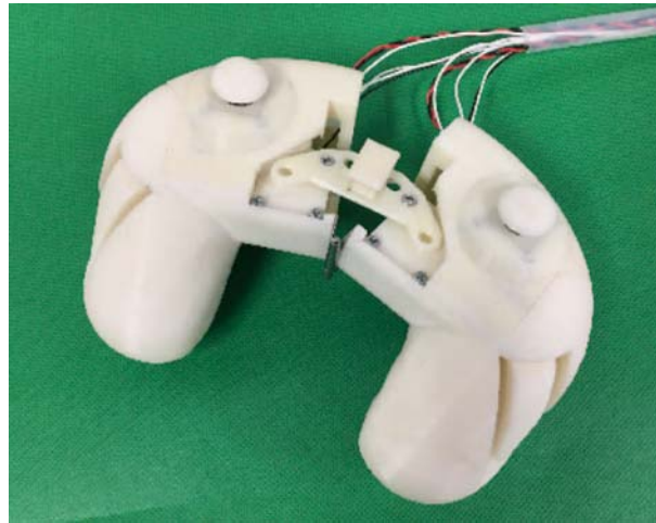
図 3.1-85 手掌部への圧刺激を活用した遠隔操作作用コントローラ
