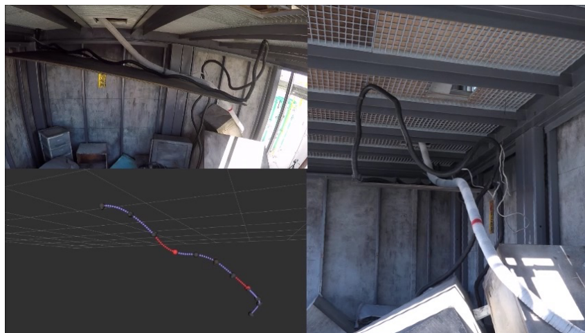
図 3.1-18 空気噴射型能動スコープカメラの接触状態の推定と姿勢との重畳表示の様子（福島ロボットテストフィールドでの評価）
