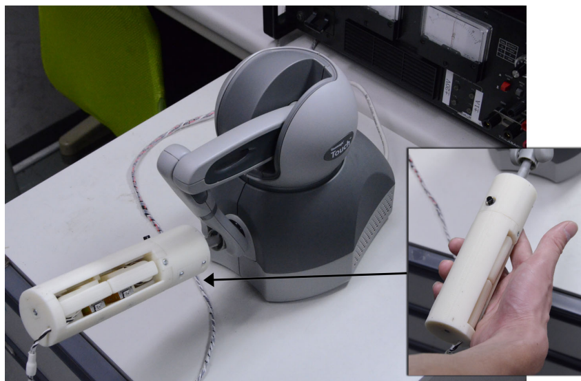
図 3.1-83 手掌部圧刺激の力覚代行効果を確認するための実験装置
