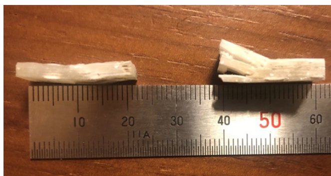
図 3.1-131 3点曲げ試験結果 (左: 硫酸バリウム粉末なし、右: 硫酸バリウム粉末添加)
