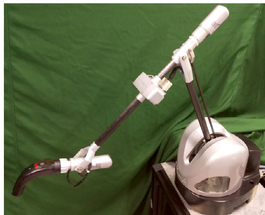
図 3.1-148 マスタアーム (Haption 社製 Virtuose 6D35-45)
