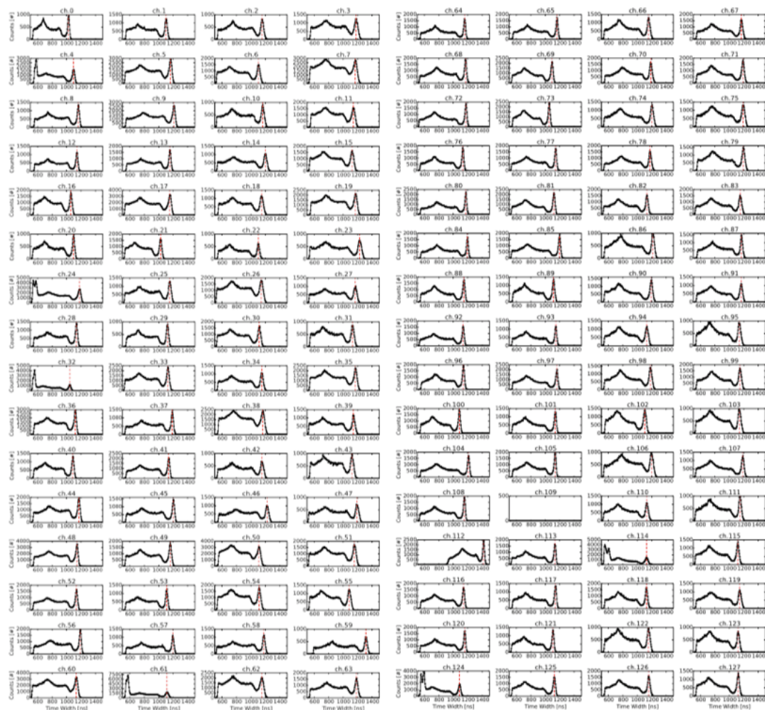
図 3.2-50 開発したコンプトンカメラにより測定した ^{137}\text{Cs} の波高スペクトル (全 128 チャンネル)
