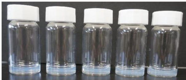
照射後2wt%スメクトンST+ホウ砂複合ゲル（左）浸漬前（右）浸漬・上澄み除去後
