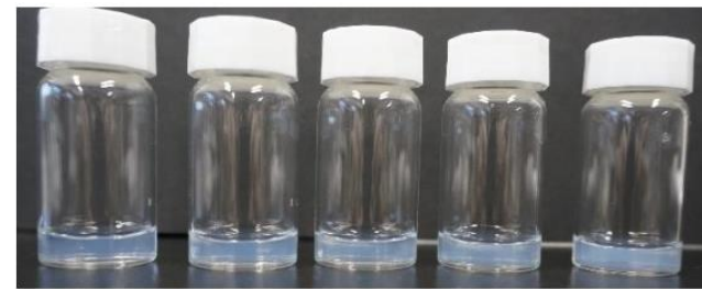
照射後2wt%スメクトンST+ホウ砂複合ゲル（左）浸漬前（右）浸漬・上澄み除去後
