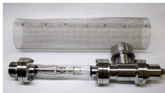
図3 開発した FEA・光電変換膜を用いた模擬撮像管 真空封止した模擬撮像素子を用いてガンマ線照射前後の光検出特性の評価を行いました。
