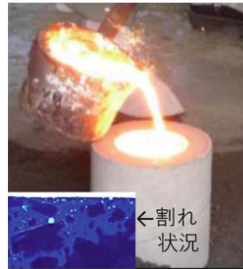
図9 コンクリートへの鉄注入熱影響による強度特性変化の評価
