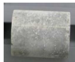
図2 酸化試験後の耐酸化燃料要素(模擬)
