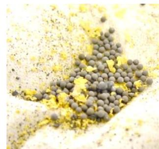
図4 取り出された模擬被覆燃料粒子の例(KOH法)
