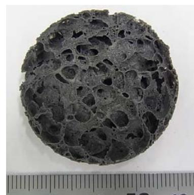
図 2 試作したジオポリマー触媒
