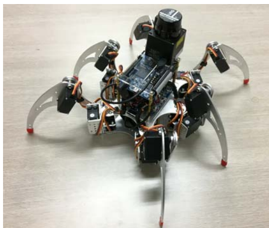
図 7 : FPGA 部 (上) とフルハードウェア制御による移動ロボット (下)
