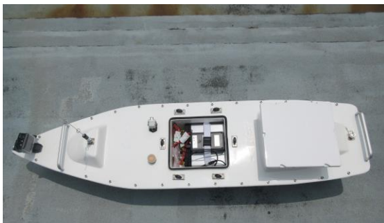
図 6 線量計を搭載した小型ボート
