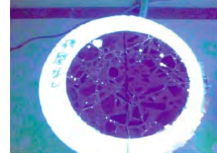
図8 加熱で生じた試料中の割れ
