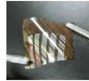
(b) 有機 PD によるフィルム型素子
