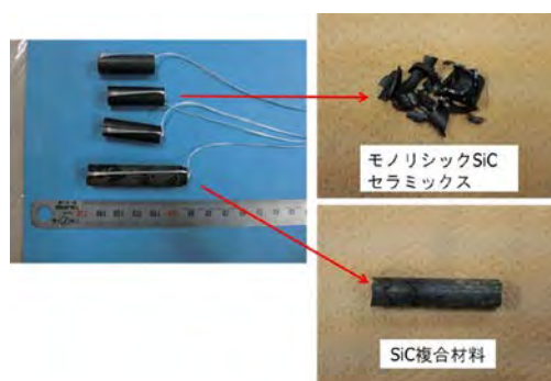
図 14 熱衝撃試験前後の外観
