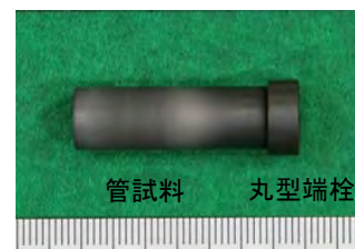
図 13 接合試験（管一端栓）
