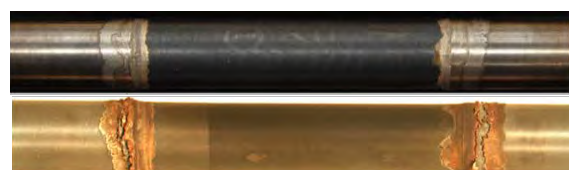
図 6 照射試験前後の SiC/SiC セグメント外観観察結果
