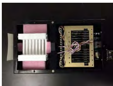
図4 光読み出しシステムの写真。左の白い棒は側面処理したシンチレータ
