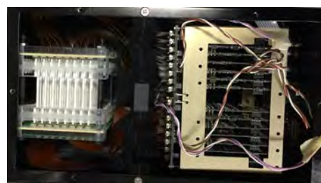
図7 高線量率版ガンマイメージャ写真。左部白い棒が1mm角の棒状シンチレータ。
