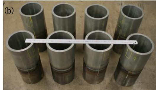
図2 TIG溶接後の(a)同材溶接試験体と(b)異材溶接試験体の外観写真
