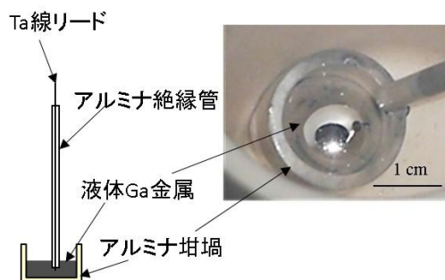
図2 液体 Ga 電極の構造。
