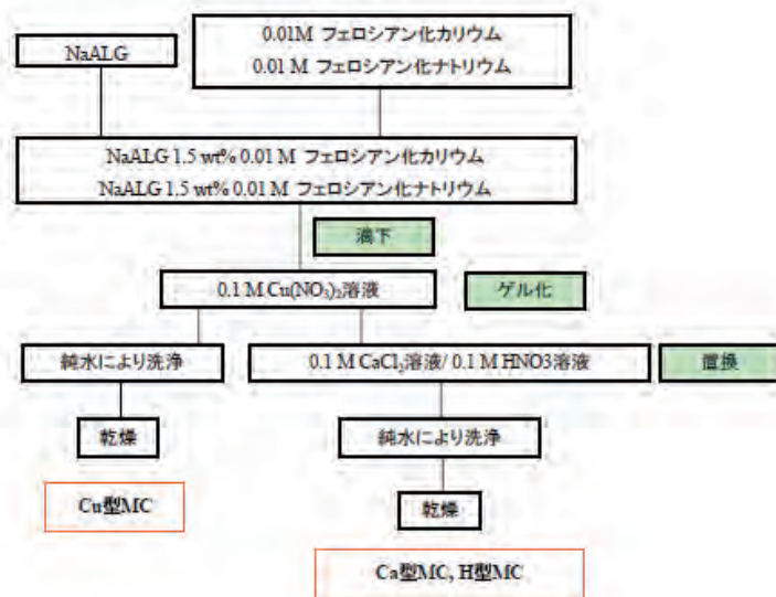
図3 新規ゾル・ゲル法による KCuFC-キセロゲル吸着剤の合成フローシート
