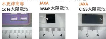
3つの太陽電池に着目し、サブストレータ構造で作製
