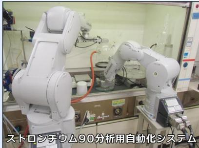
を駆使して全て自動化することによって、分析の圧倒的な効率化・経済化を達成できる点において革新的である。これまでに開発した放射性ストロンチウム分離システムでは加熱酸分解・沈殿ろ過・イオン交換といった3段階の作業を別々にはあるが全て自動化した。本研究ではこれら別個の自動化システムを統合することで全ての作業を自動で行うシステムの開発を目指す。本研究では以下の5つの実施項目を立てている。
