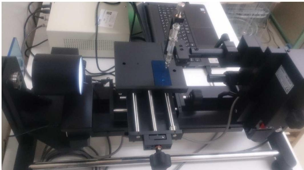
図 3.1-2 実験装置の KYOWA Drop-Master DMo-501 接触角計
