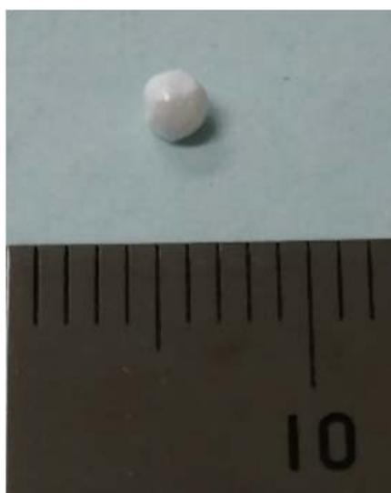
図 3.3-5 : ガス浮遊溶融装置によって溶融させた Al<sub>2</sub>O<sub>3</sub>-ZrO<sub>2</sub> 試料の外観
