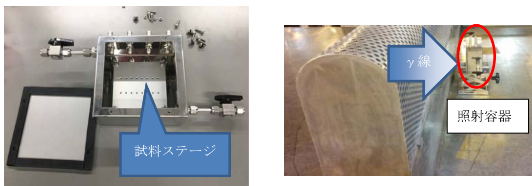
図 3.3-1 ガンマ線照射容器の外観および照射の様子
