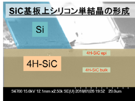
図 3.2-7 4H-SiC 基板上に Si デバイス層を形成
