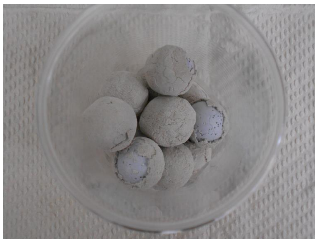
図 3.1.3-15 剥離後の外観
