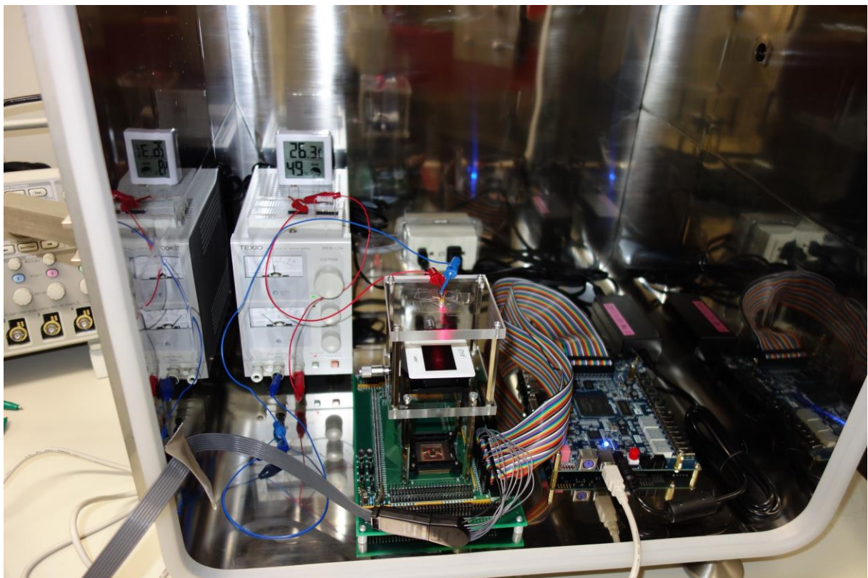
図 3. 1. 1-13 図 3. 1. 1-9 の光再構成型ゲートアレイシステムに対する \alpha 線試験の様子
