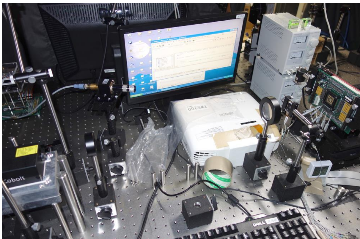
図 3. 1. 1-8 光再構成型ゲートアレイ VLSI の伝搬遅延計測の様子
