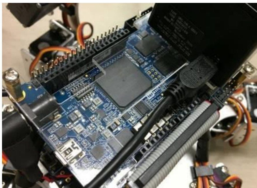
図 3.2-1 Cyclone V SoC FPGA を搭載したロボット制御基板
