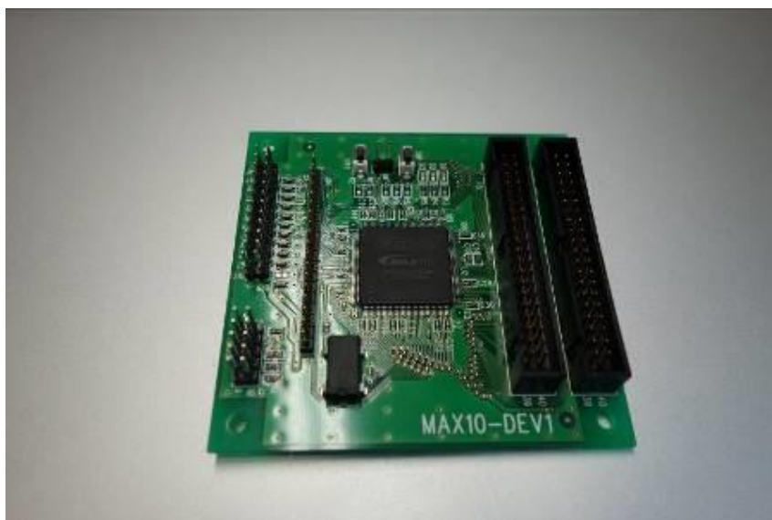
図 3.1.1-2 CPLD を用いた耐放射線評価基板
