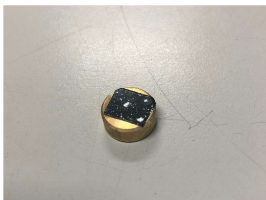
図 3. 1. 4-28 実験後の硫酸バリウムが付着した試料台
