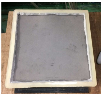
図 3.1.4-14 焼結フィルター装着時の装着治具 図 3.1.4-15 装着治具 WF 挿入時
