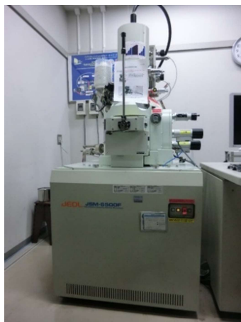
図 3.1.4-12 電界放出型走査電子顕微鏡 (FE-SEM) 図 3.1.4-13 WF の SEM 観測画像
