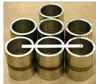
溶接後試験体
