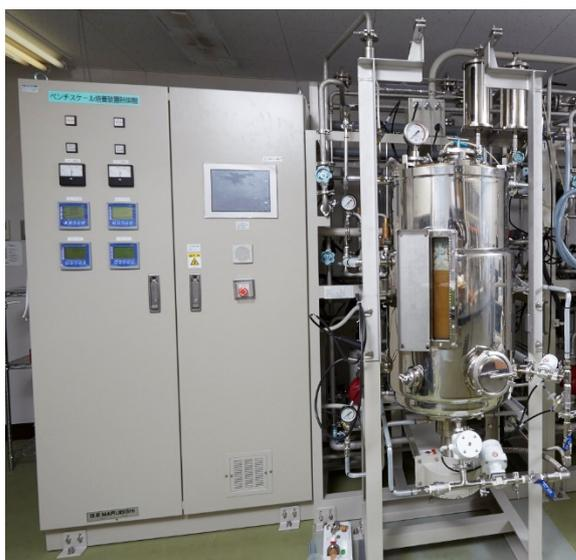
図 3.1-12 100 L ベンチスケール培養装置の外観
