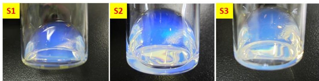
図 3.1.20 非水溶媒中のコロイダルシリカ粒子のフォトニック結晶化の検討結果
