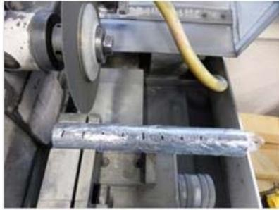
a) ナストンゴールドと高速カッターによる切断状況
