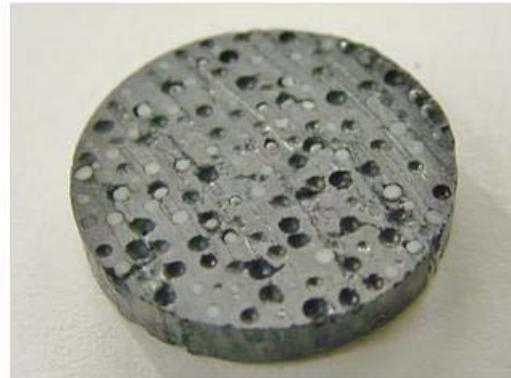
d) 切断ホイールと精密切断機による切断面
