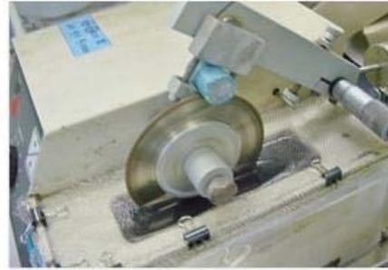
b) 切断ホイールと精密切断機による切断状況
