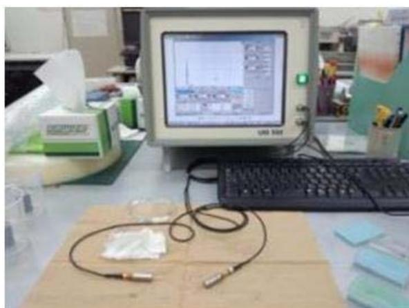
図 A-8. 2-2 インテリジェント超音波探傷器(KJTD Co., Ltd. 製、USI550)
