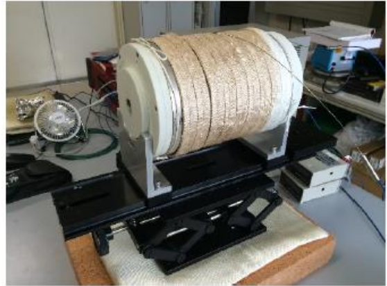
図 90 温度サイクル試験
