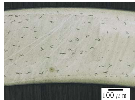
図1. J1合金の腐食後エッチング組織
