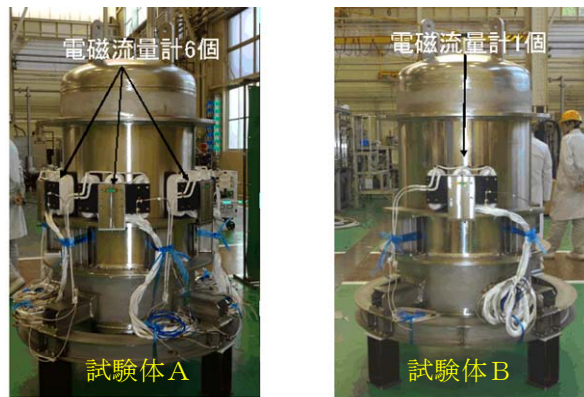
図 3 電磁流量計試験体外観
