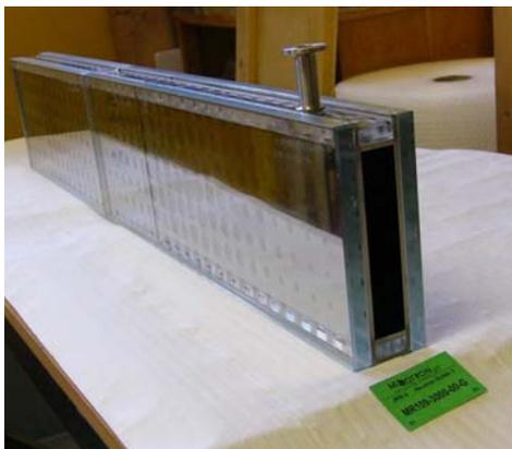
図 3. 製作したスーパーミラー型冷中性子鏡管ユニット。
