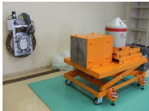
第2図 オープンスペース型 即発 \gamma 線分析装置
